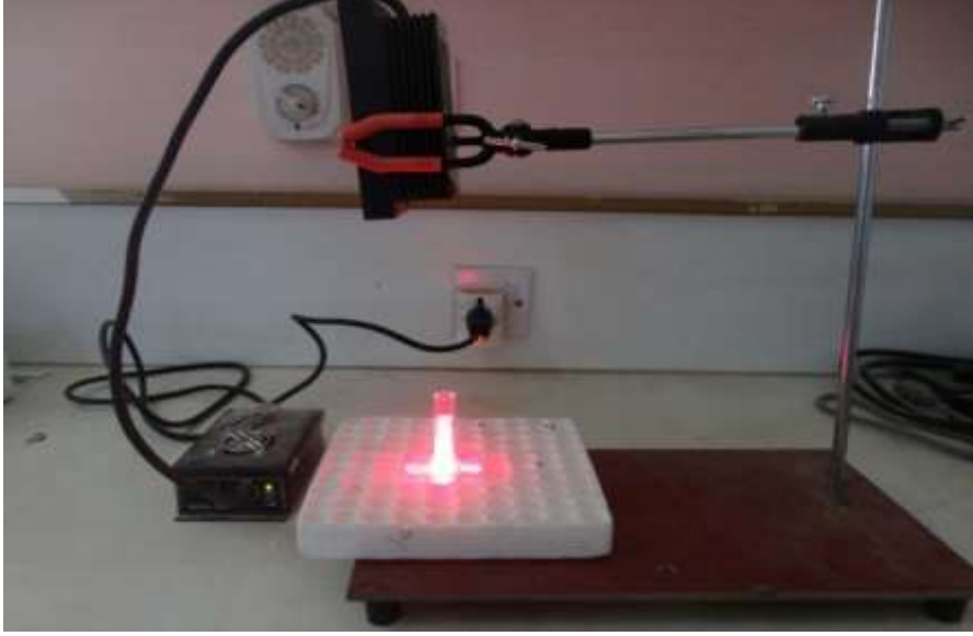
شكل (2-2) يوضح التشعيع بالليزر 650nm
