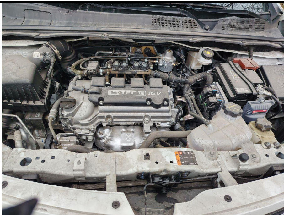
2- rasm. Kobalt avtomobiliga o'rnatilgan 4- avlod propan bilan ta'minlash tizimi
