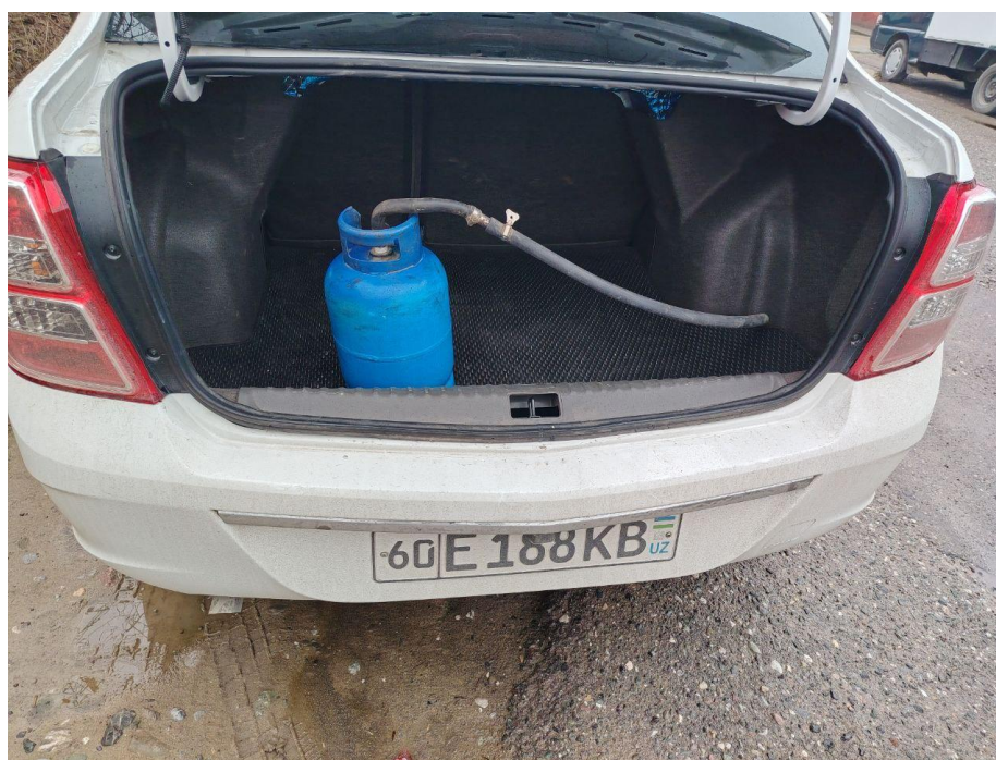
1- rasm. "Kobalt" avtomobiliga o'rnatilgan spirt tizimi
